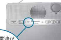
通常は各家庭用電源で動作していますが、停電時は電源が内蔵されている乾電池に自動的に切り替わります。
