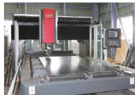
山口鉄工所で使う高出力のCO 2 レーザー加工機。厚さ最大 25mm の金属を滑らかに切断できるパワーが持ち味。
