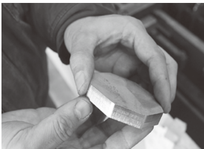
窒素ガスを用いた特殊な切削加工が施されたステンレス製の部品。
