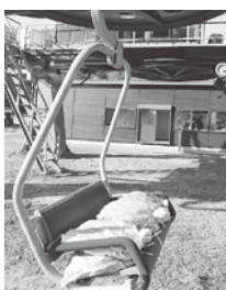
制動試験の様子。乗客に見立てた120kgの重りをのせ、試験を行う。
